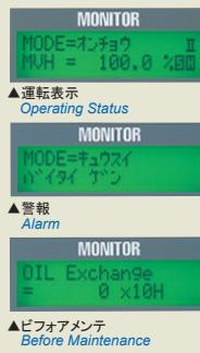
高精度の温度制御と高安全性を追求するとともに、保守点検時期などの液晶表示メッセージが簡易に出来ます。
